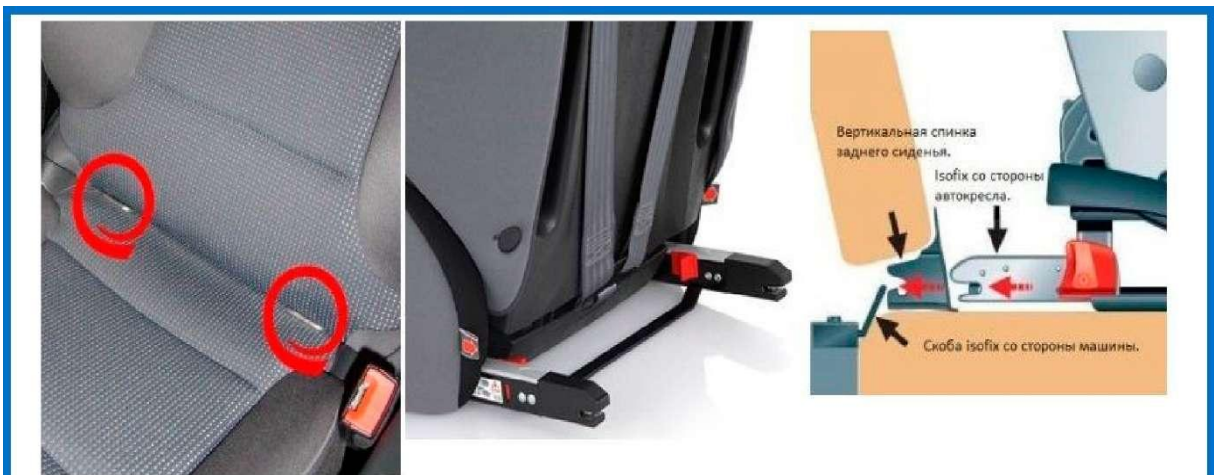
Ответные петли isofix в машине./ Isofix сзади детского автокресла./ Схема в разрезе.
